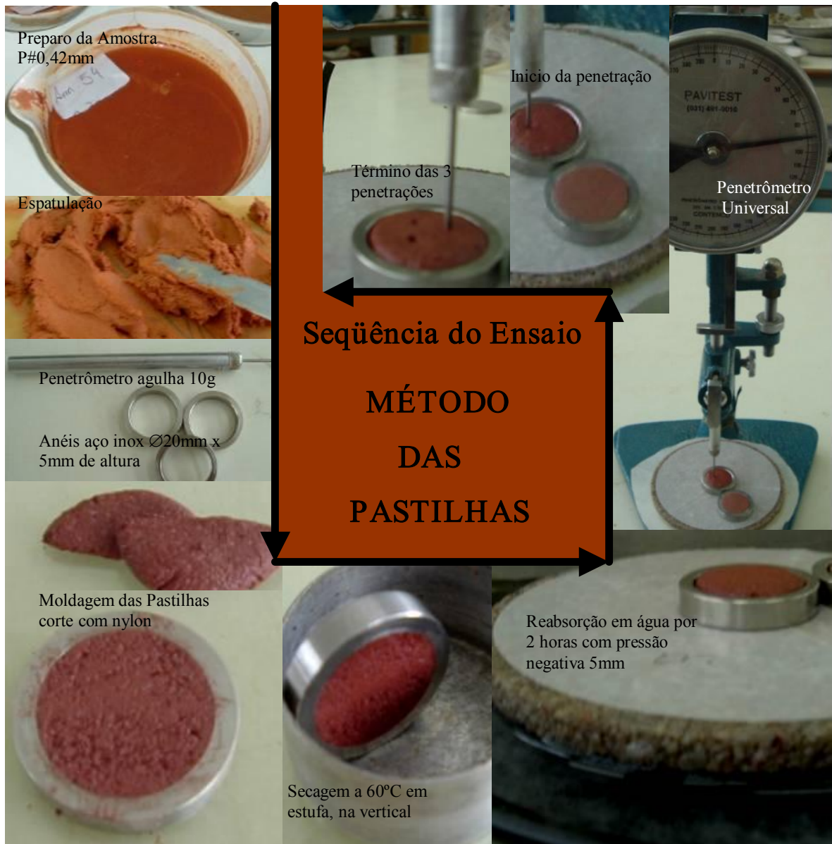
Figura 3: Seqüência de realização do ensaio MP da metodologia MCT.
