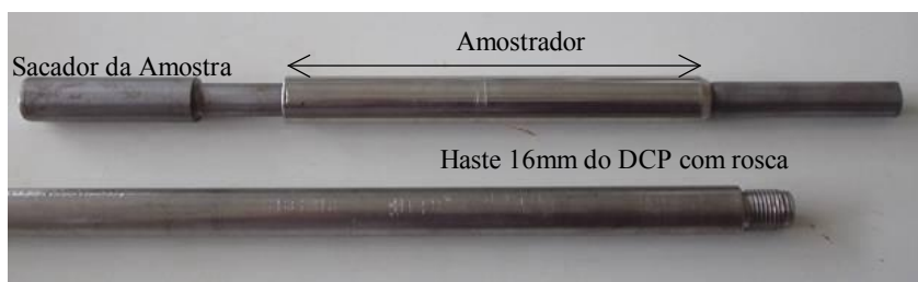
Figura 6: Haste do DCP e tubo amostrador de 16mm de diâmetro por 150mm de comprimento.
