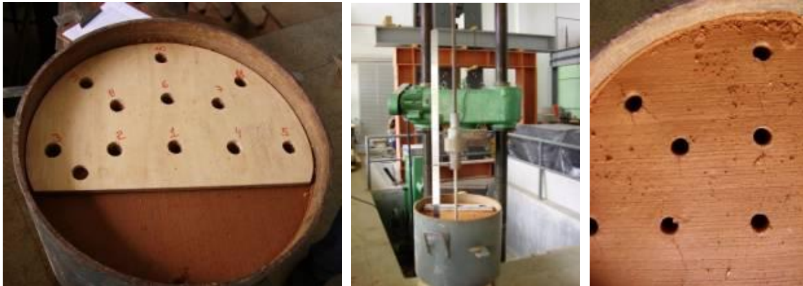
Figura 10: Realização do ensaio DCP no CP de grandes dimensões: a) CP prensado e gabarito, b) execução do ensaio DCP e c) CP após penetração do DCP (AM03).
