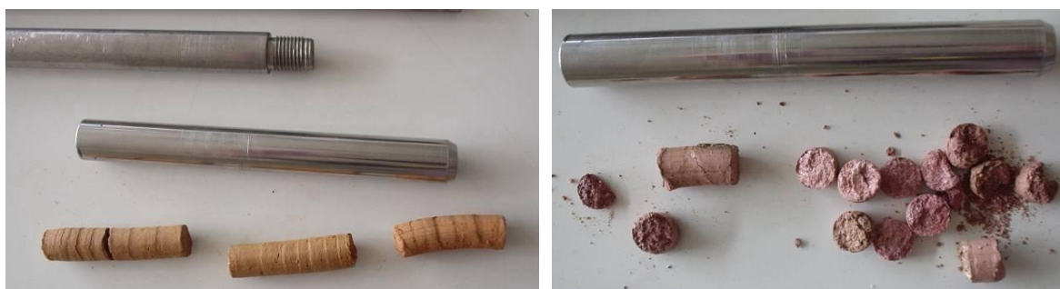
Figura 7: Coleta de amostra para a determinação de umidade em perfis de solo de horizontes B (AM03 - LG') e C (AM02 - NG'/NS') da Unidade Pedológica Cambissolo do bairro Jardim Acaraí.
