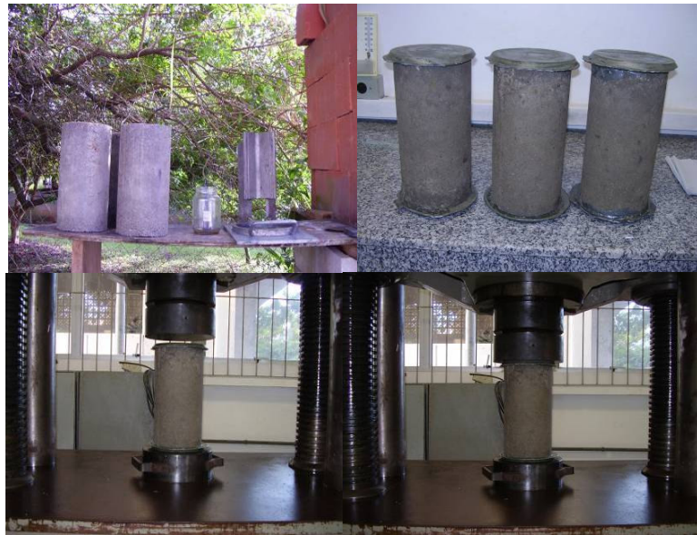
Figura 4.21 – Procedimento adotado para a realização do capeamento e ensaio de resistência à compressão simples dos CP's de CCR
