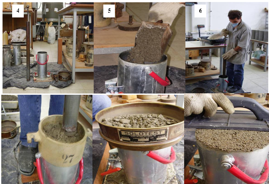
Figura 4.15 – Equipamentos e procedimentos adotados para produção dos CP's de CCR
