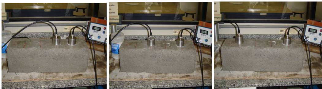
Figura 4.42 – Ensaio de pulso do ultra-som em CP's prismáticos 15 x 15 x 50 cm
