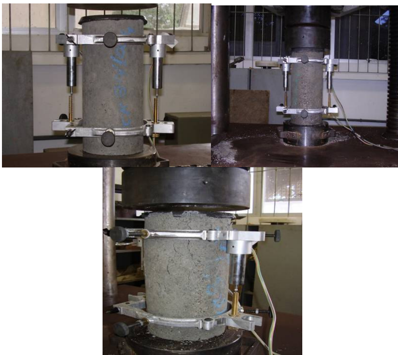
Figura 4.26 – Seqüência adotada na execução do ensaio de módulo de elasticidade
