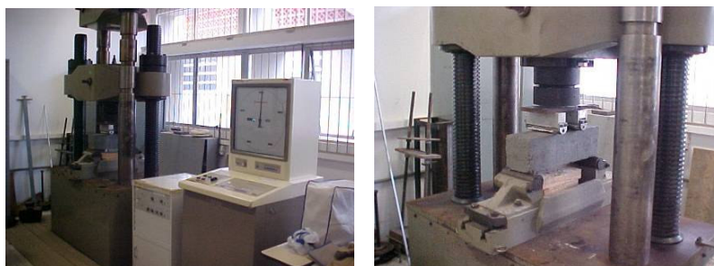
Figura 4.35 – Ensaio de resistência à tração na flexão com prensa hidráulica
