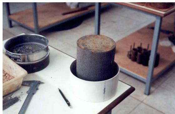
CAP de PVC com as camadas iniciais e o corpo-de-prova de cinza pesada, compactado na umidade ótima e a 100% do PN, sobreposto.
