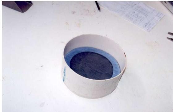
CAP com a camada de brita inicial de 5,0cm, o geotextil não tecido e o anel de PEAD sobrepostos.
