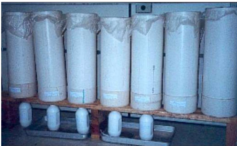
Figura 3.4 - Células de percolação e coletores de líquido percolado posicionados.
