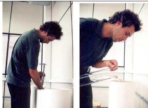
Com a célula de percolação montada, marcou-se com um paquímetro a altura de coluna d'água adotada para o ensaio e completou-se com a solução de percolação preparada para o ensaio.
