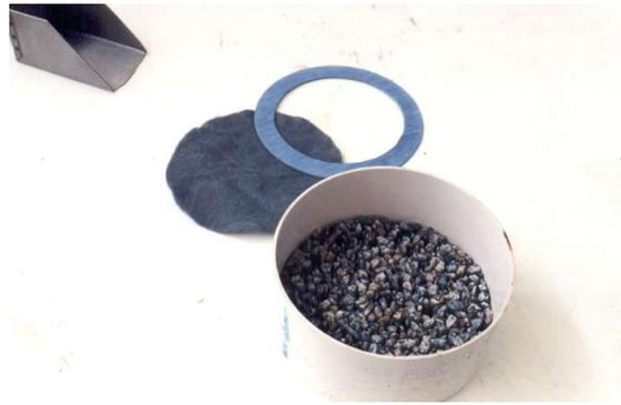
CAP com a camada de brita inicial de 5,0cm e, ao lado, o anel de PEAD (Polietileno de Alta Densidade) e o geotextil não tecido.
