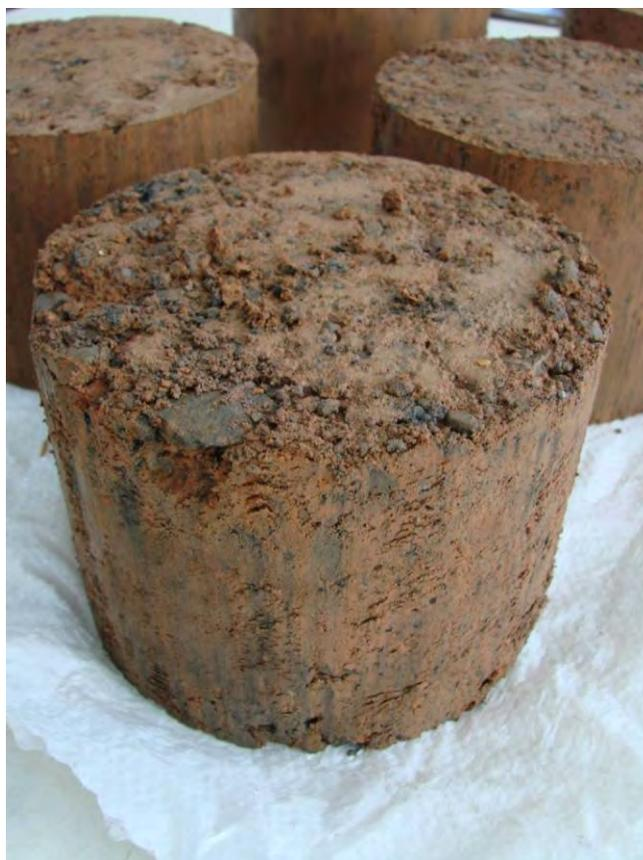
**Foto 3.11 - Corpo de prova - Mistura Escória de Aciaria e Solo**
