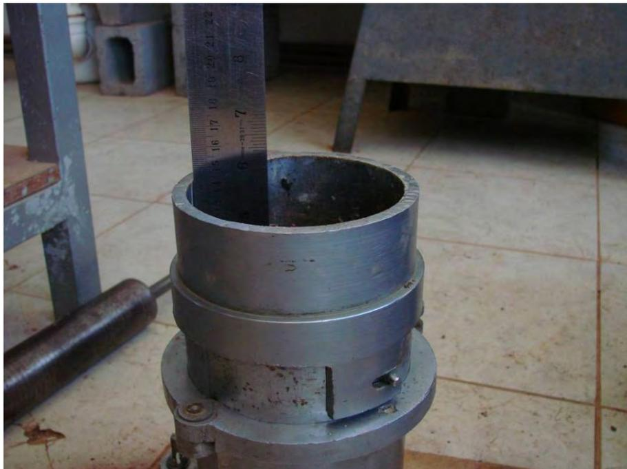
**Foto 3.15 - Verificação da altura das camadas para se adequar o número de golpes necessários para reproduzir a MEAS máxima**
