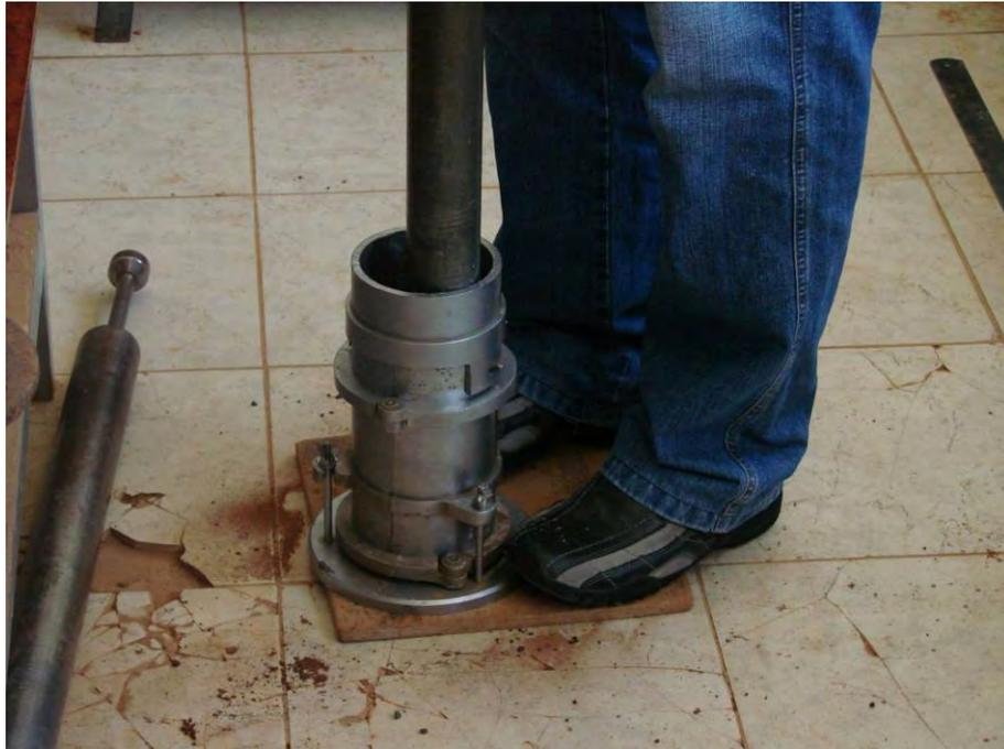
**Foto 3.14 - Compactação do corpo de prova**
