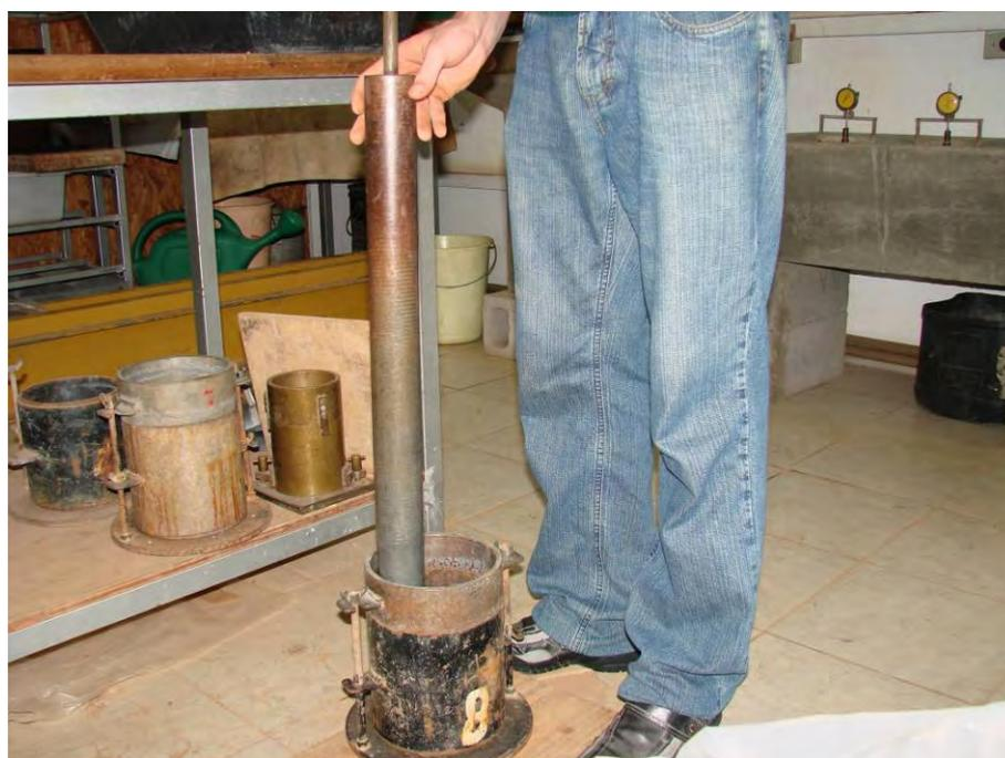
**Foto 3.9 - Compactação do corpo de prova (02)**
