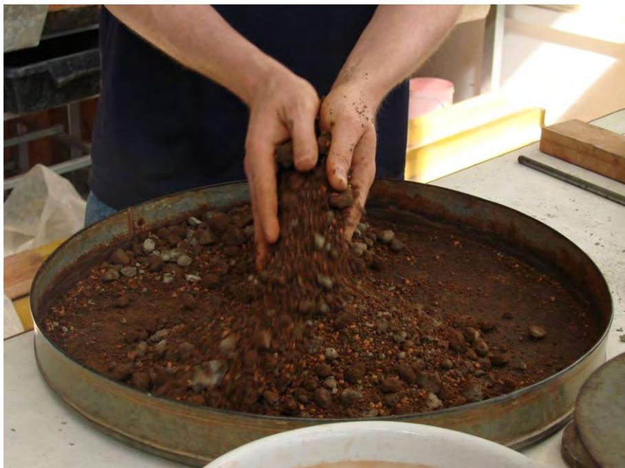
**Foto 3.12 - Homogeneização da mistura nas condições de hót**
