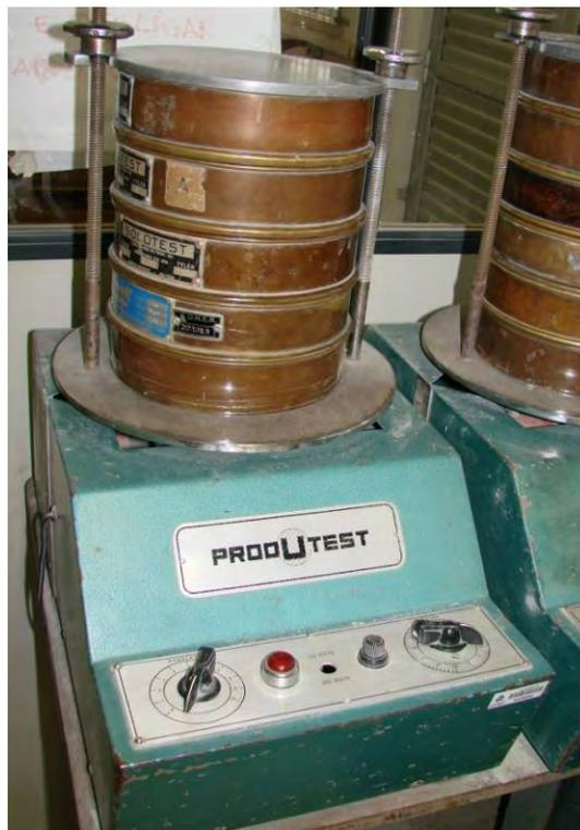
**Foto 3.4 - Peneiramento mecanizado**
