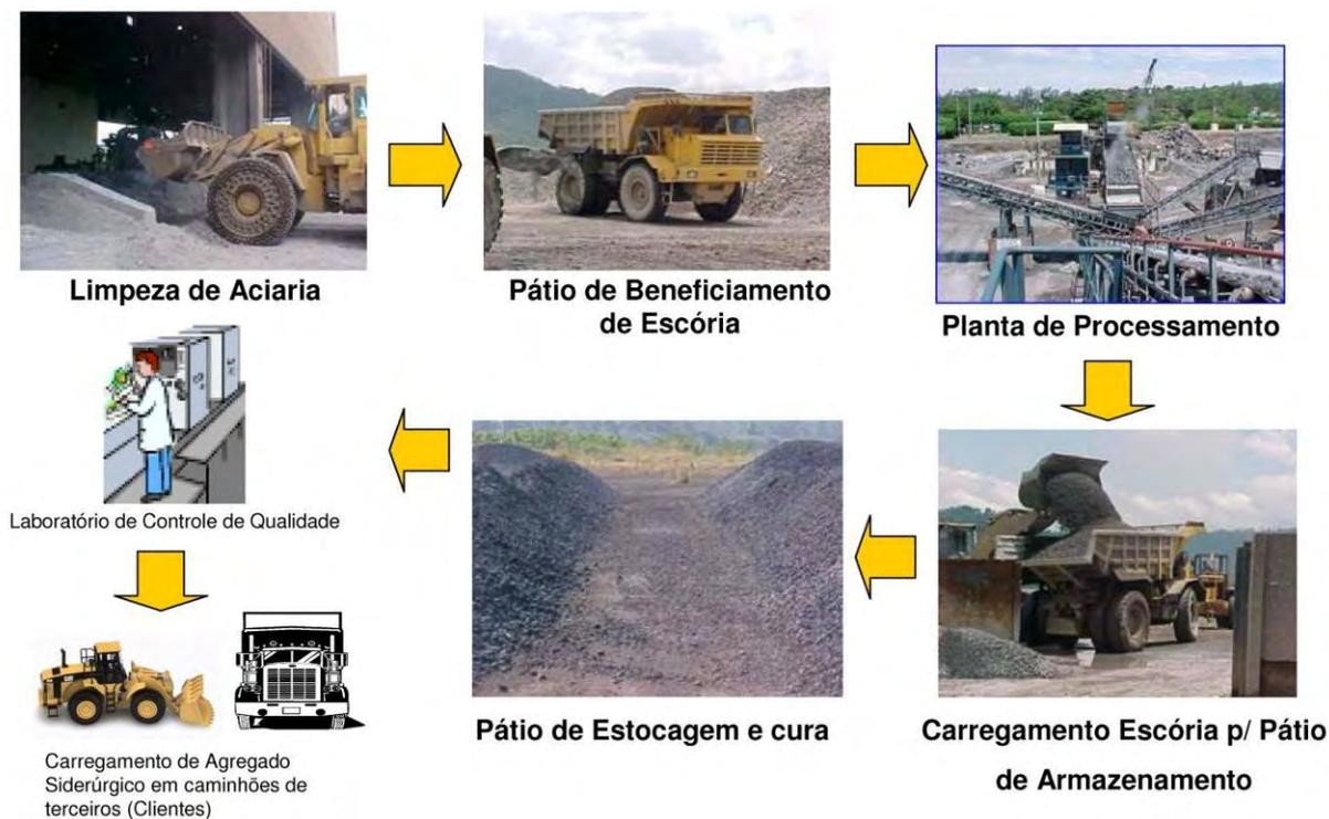
**Figura 1.2 - Fluxo do processo para obtenção da escória de aciaria**
