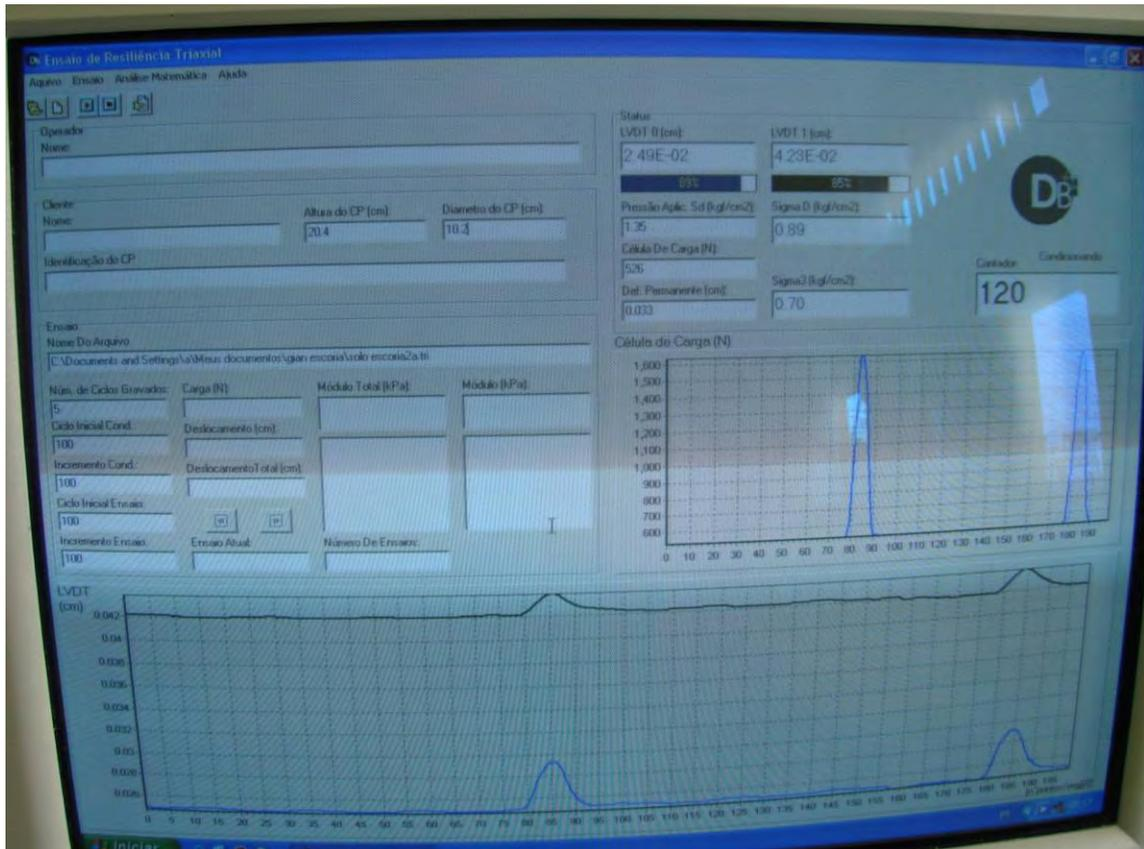
Foto 3.19 – Tela do Programa do Ensaio Dinâmico Triaxial
