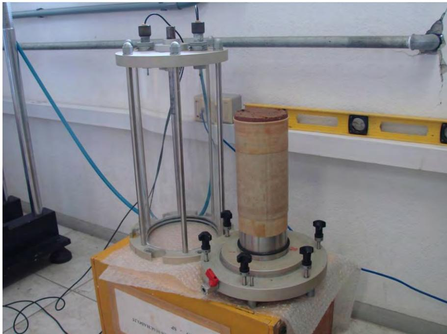
**Foto 3.16 - Corpo de prova com membrana**
