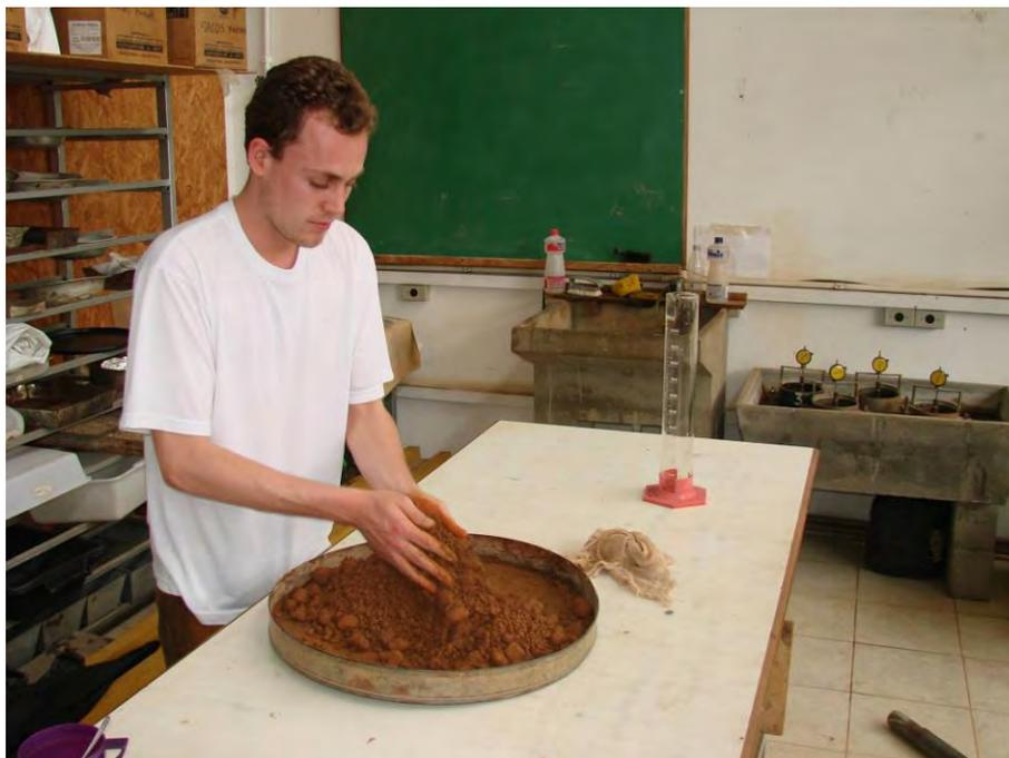
**Foto 3.6 - Homogenização da mistura Escória/Solo**
