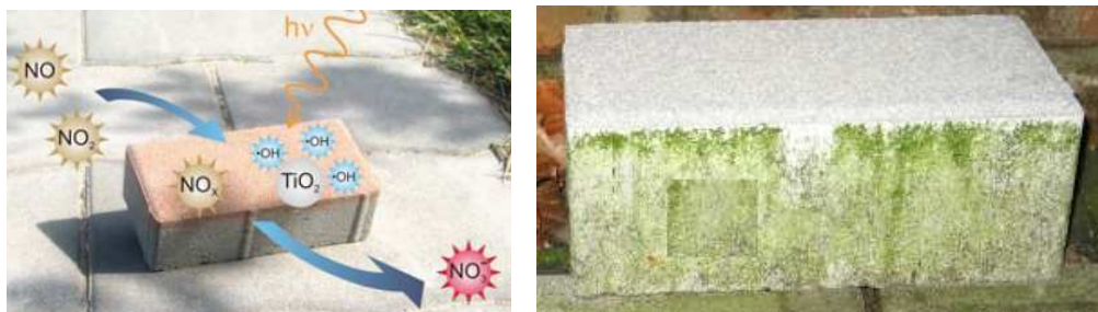
Figura 3. Peças Pré-Moldadas com Argamassa Fotocatalítica (HÜSKEN et al. , 2009).
