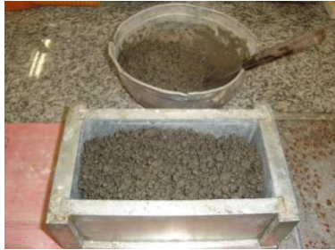
Figura 4.16 – Compactação da Camada de Base.
