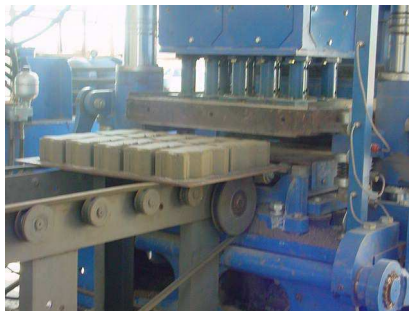
Figura 2.19 – Vibro-Prensa de Desforma Imediata (CRUZ, 2003).
