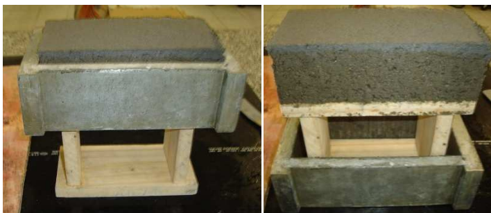
Figura 4.19 – Extração da PPC Fotocatalítica.
