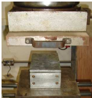
Figura 4.18 – Compactação da PPC na Prensa Hidráulica.
