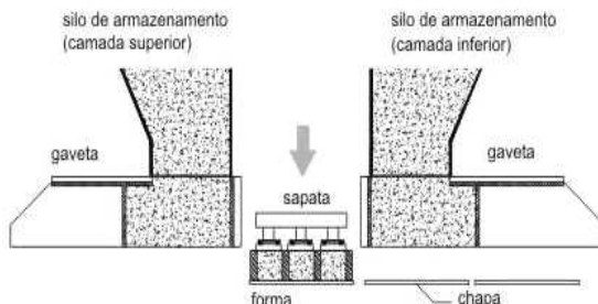
Figura 2.23 – Etapa de Vibro-Compressão da Produção de PPC (OLIVEIRA, 2004).
