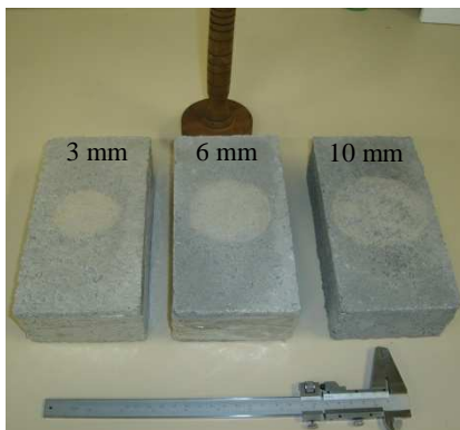
Figura 4.25 – Ensaio de Mancha de Areia Sobre as PPCs Fotocatalíticas.
