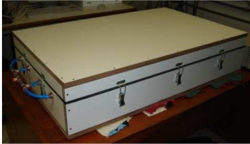
Figura 4.4 – Vista Exterior da Célula do Fotoreator Desenvolvido Nesta Pesquisa.
